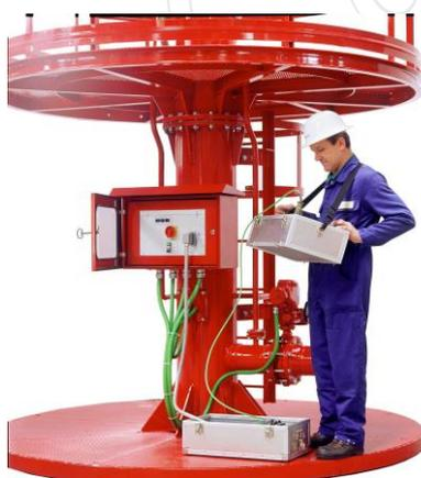
Der vor dem Bauch getragene Teil enthält alle Steuerelemente und Anzeigen zum Bedienen der Anlage, wogegen der am Boden befindliche Teil die Stromversorgung, Notstrombatterie und die Anschlüsse an die Kommunikationsschleife enthält. Unter normalen Umständen wird die UZKp aus der Ringleitung, an die alle Einheiten angeschlossen sind, mit Strom versorgt und die Notstrombatterie wird geladen, bzw. deren Ladung erhalten. Sie kann aber auch getrennt an einer 230V/50Hz Steckdose aufgeladen werden.
