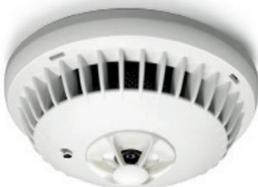
Rilevatore termico con comportamento differenziale e di massima risposta per loop3000 per il riconoscimento e la segnalazione precoci incendio in condizioni ambientali difficili, con un sensore termico ed un isolatore bidirezionale in accordo alle EN 54-5 e EN 54-17.
