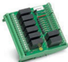
Modulo per il collegamento alla centralina detect 3004<sup>plus</sup> di fino a 8 ulteriori uscite tramite relais a scambi multipli
