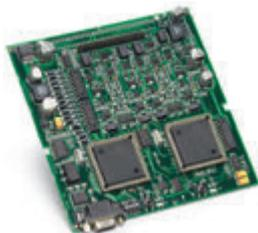
Interfaccia di linea controllata da microprocessore per l'utilizzo a prova di corto circuito dei componenti della serie loop3000.
